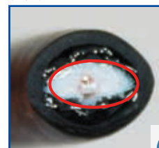
Mauvaise diélectrique ovale
